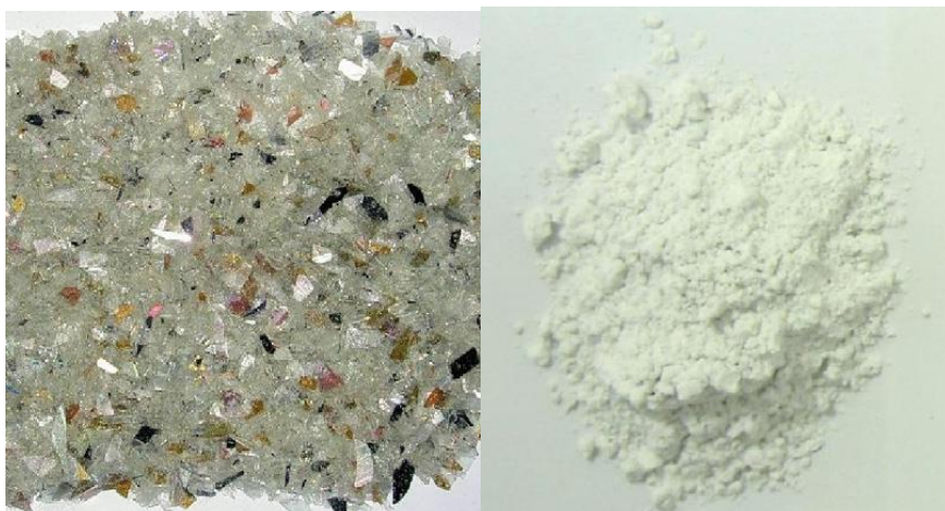
Slika 4. Otpadno LCD staklo: Stakleni lom (lijevo) i stakleni prah (desno) [8]
