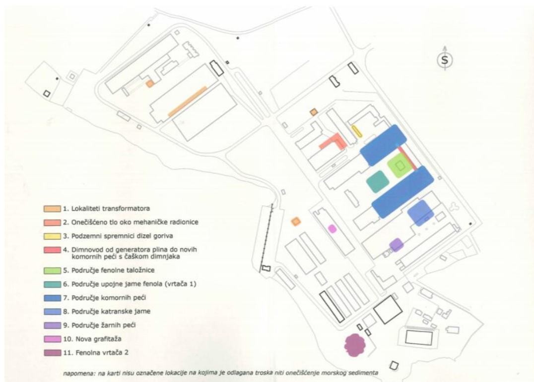
Slika 1. Vrste i lokacije prisutnog otpada i onečišćenja tla na lokaciji bivše Tvornice elektroda i ferolegura zatečene 2006. godine [6]
